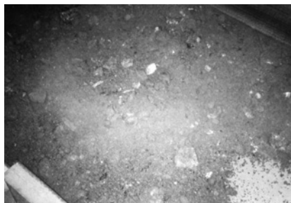
写真 2-10 土砂・がれきの目立つ主灰
